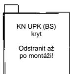
**KN-UPK** Plastová skříňka pod omítku chráněna stavebním zakrytím (před znečištěním-malta) a vyvedením kabelu.
